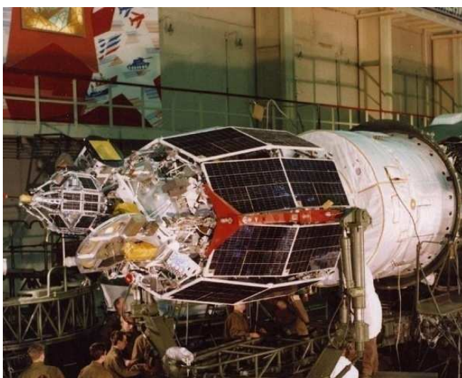
Magion 2 připevněný na mateřské družici a dále (v pozadí) na nosné raketě. Na fotografii je také vidět svinutá dvacetimetrová anténa na mateřské družici, která se po oddělení Magionu 2 měla rozvinout (žlutý kotouč vpravo dole od Magionu).
