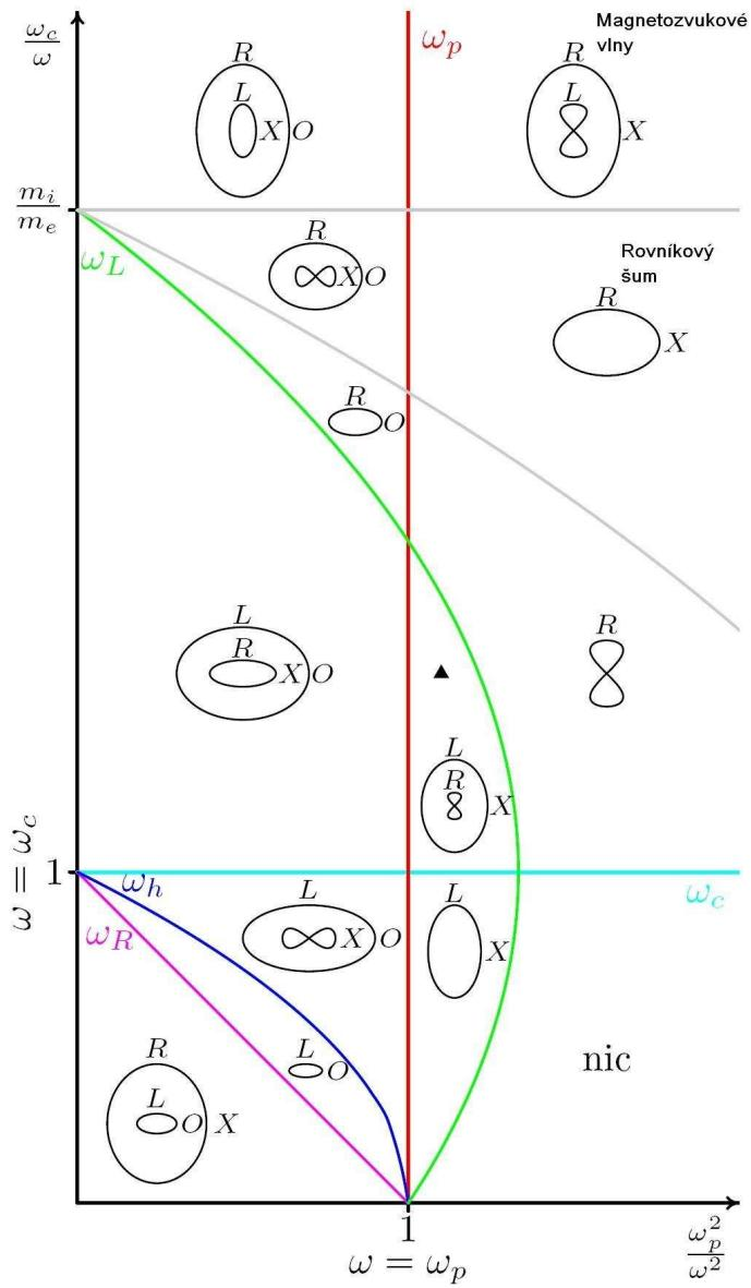
Obrázek 2.2: Uvedený Clemmow-Mullaly-Allis diagram pojmenovaný podle jeho tvůrců platí pro dvousložkové plazma (pouze elektrony a protony). Osa  $y$  je úměrná statickému magnetickému poli a osa  $x$  hustotě plazmatu. Diagram je rozdělen do 13 oblastí, na jejichž hranicích je index lomu pro příslušné vlnové módy dané oblasti  $N=0$  nebo  $N = \infty$ . Tedy dochází buď k ořezání vln, či k jejich rezonanci. Převzato z [4].
