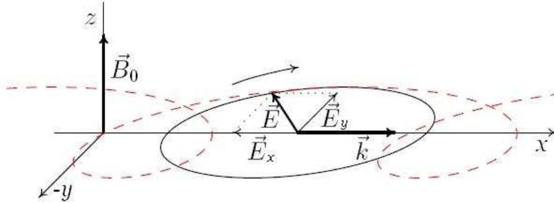
Obrázek 2.1: Orientace os a směr vnějšího magnetického pole pro odvození disperzní relace pro anizotropní plazma. Na obrázku je dále ukázán směr a typ polarizace elektrického pole pro  $X$ -mód. Obrázek převzat z [4].
