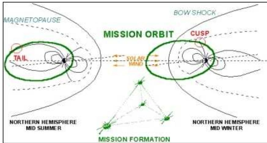
Obrázek 5.1: Orbita družic Cluster s vyznačenými oblastmi, které družice protínají - kaspy (cusp), magnetický ohon (tail), rázová vlna (bow shock) a magnetopauza. Ze středu přichází sluneční vítr. Převzato z <http://sci.esa.int/science-e/www/object/index.cfm?fobjectid=24451>.
