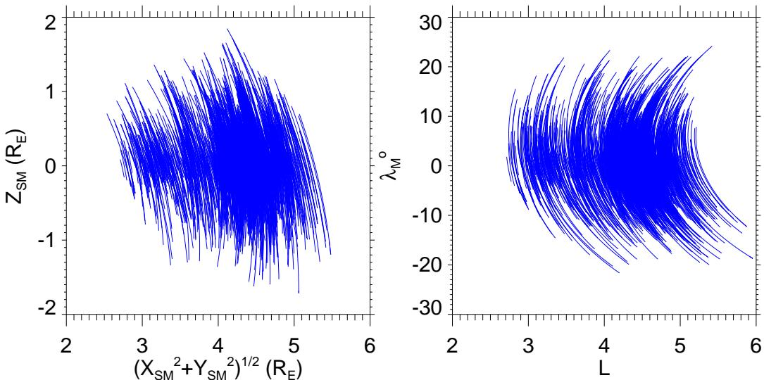
Obrázek 7.5: V levém grafu je poloha družice v závislosti na vzdálenosti na ose  $z$  (osa dipólu) a vzdálenosti v rovině  $x$ ,  $y$  (rovina geomagnetického rovníku) v souřadnicové soustavě SM. V pravém grafu je poloha družice v závislosti na McIlwainově parametru  $L$  a magnetické šířce.
